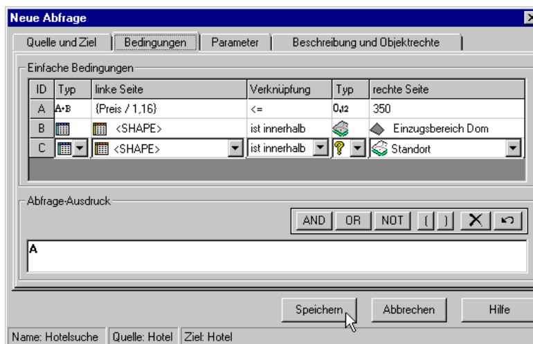
Abbildung 2.60: Kombination aus sachbezogenen und räumlichen Bedingungen
